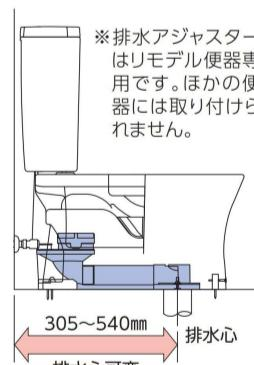
ピュアレストQRは設備排水管の移設を行わずに、便器が取り替えられるリモデル便器を用意しています。給水管はフレキホースのため、広い範囲での給水位置に対応しています。便器前出寸法が760mmとコンパクトなため、レギュラー便器からの取り替えにも適しています。
